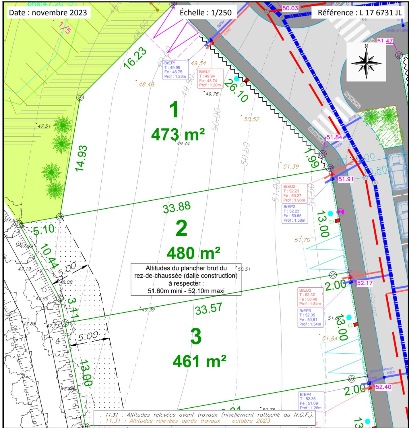
11.31 : Altitudes relevées avant travaux (nivellement rattaché au N.G.F.).
