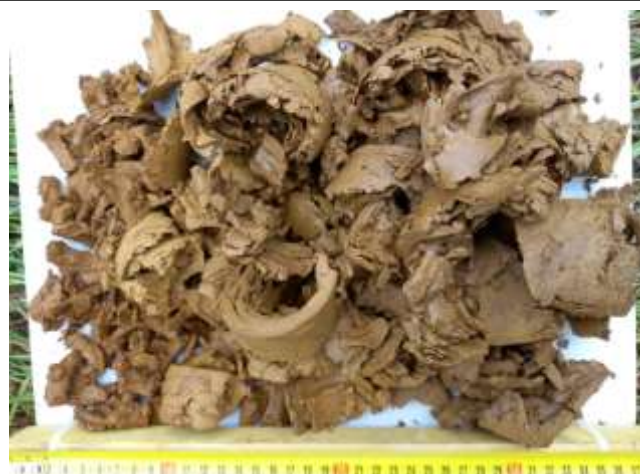
Photographie des prélèvements à la tarière T6 (faciès d'argile compacte)
