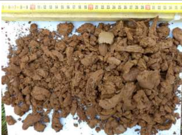
Photographie des prélèvements à la tarière T6 (faciès de terre végétale, d'argile limoneuse et d'argile compacte)
