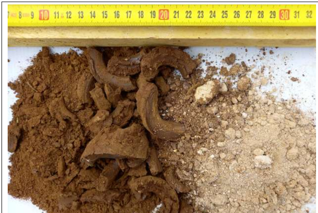
Photographie des prélèvements à la tarière T46 (faciès de terre végétale, d'argile limoneuse, de marne-calcaire et de calcaire blanc altéré)
