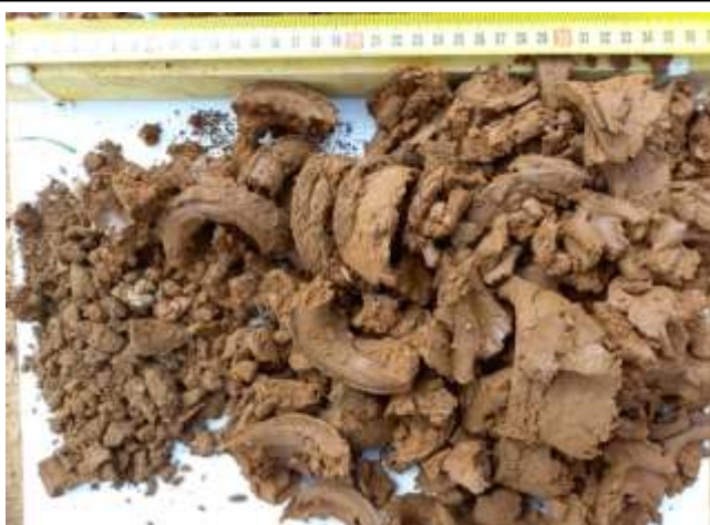
Photographie des prélèvements à la tarière T3 (faciès de terre végétale, d'argile limoneuse et d'argile compacte)
