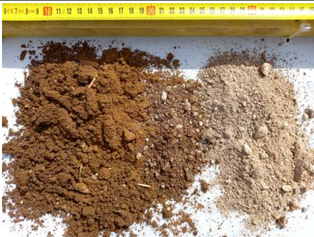
Photographie des prélèvements à la tarière T21 (faciès de terre végétale, d'argile limoneuse, de marne-calcaire et de calcaire blanc altéré)
