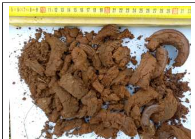
Photographie des prélèvements à la tarière T20 (faciès de terre végétale et d'argile limoneuse)
