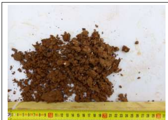
Photographie des prélèvements à la tarière T20 (faciès de marne-calcaire)
