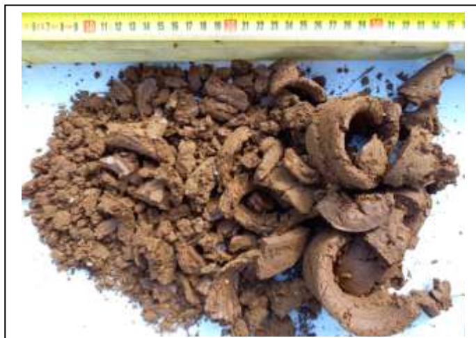
Photographie des prélèvements à la tarière T19 (faciès de terre végétale et d'argile limoneuse)
