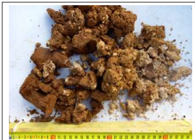
Photographie des prélèvements à la tarière T19 (faciès de marne-calcaire et de calcaire blanc altéré)
