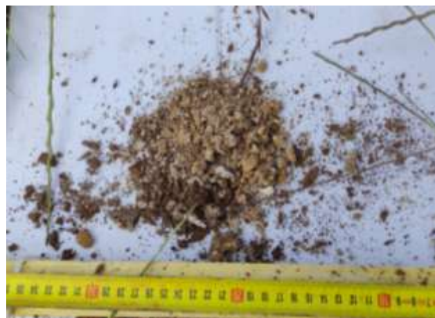
Photographie des prélèvements à la tarière T12 (faciès de marne-calcaire)
