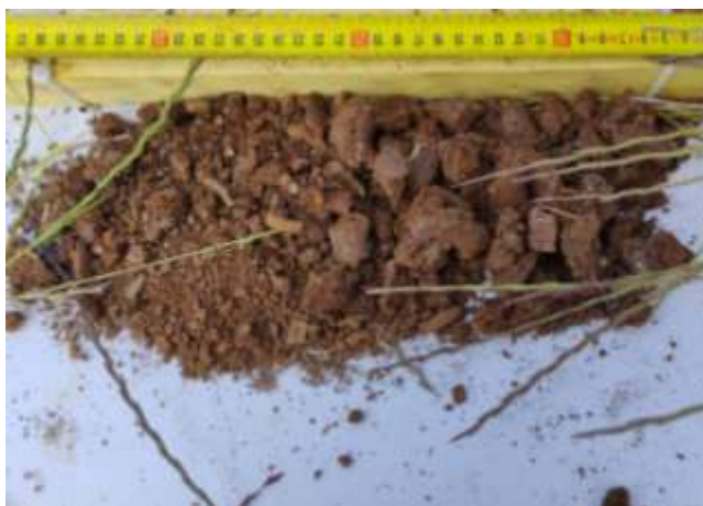
Photographie des prélèvements à la tarière T12 (faciès de terre végétale et d'argile limoneuse)
